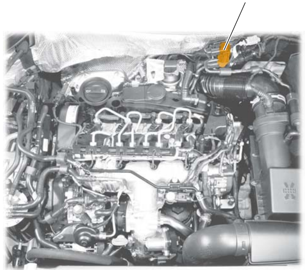
Turbo basıncını sınırlayan solenoid valf N75
