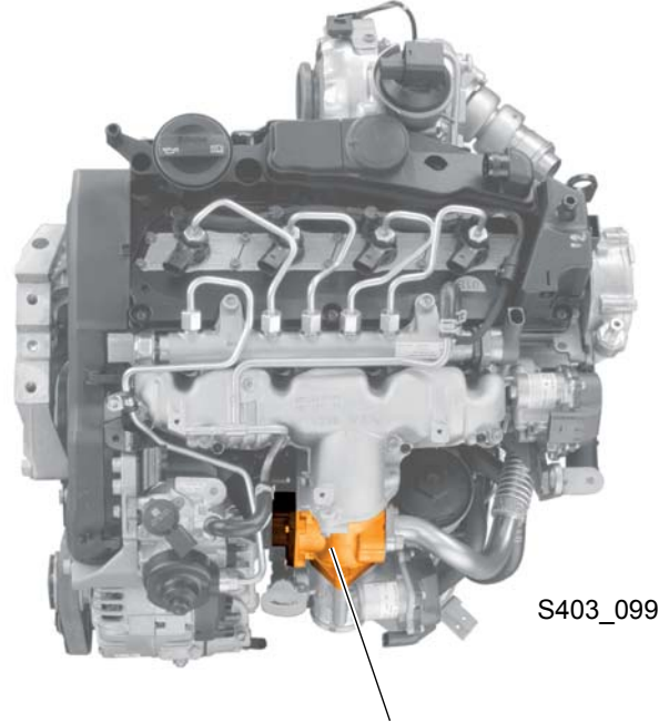
Egzoz gazı geri dönüş potansiyometresi G212 egzoz gazı geri dönüş valfı N18
