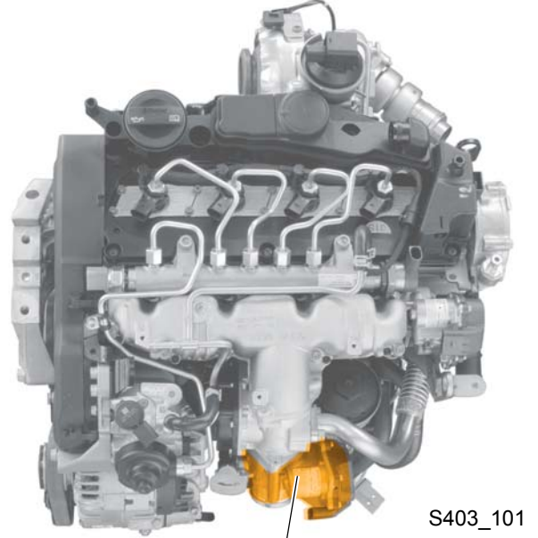
Gaz kelebeği potansiyometresine G69 sahip gaz kelebeği kumanda ünitesi J338
